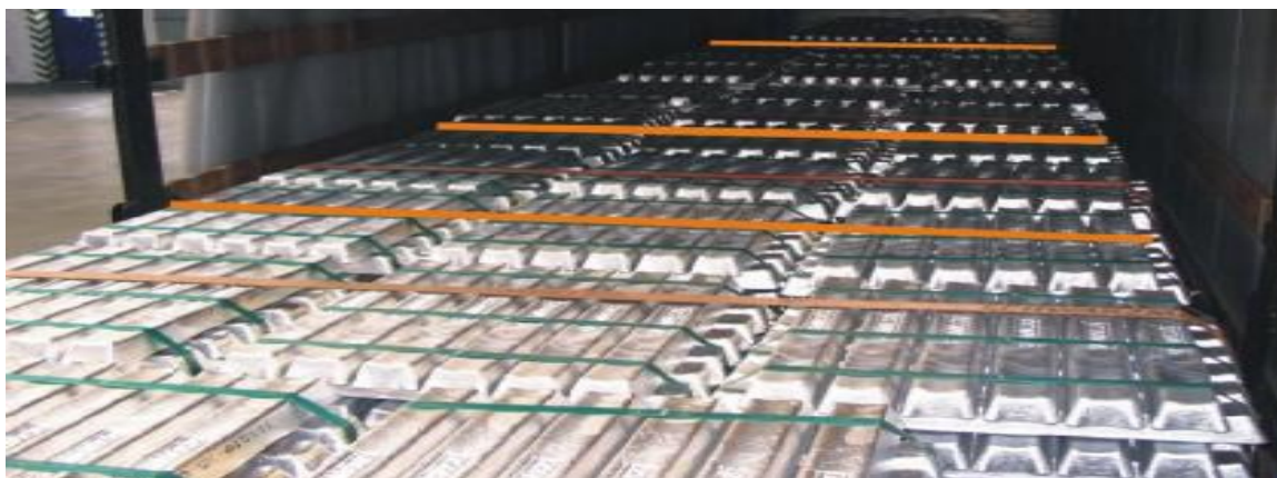
Kompaktný spôsob uloženia paliet (42 jednotiek) – každá sekcia upevnená vrchným viazaním - náklad blokový o čelo vozidla dostatočnej pevnosti
