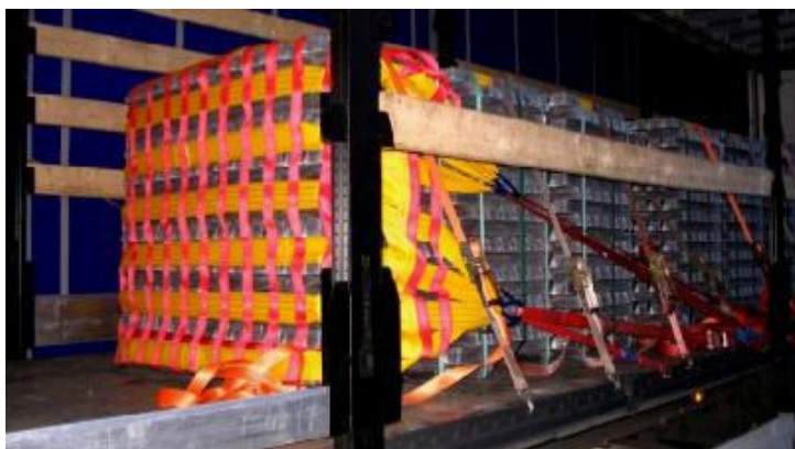
Upevnenie paliet dopredu sieťou AGRIFAIR – 4 pružné dvojité viazania do 20 ton
