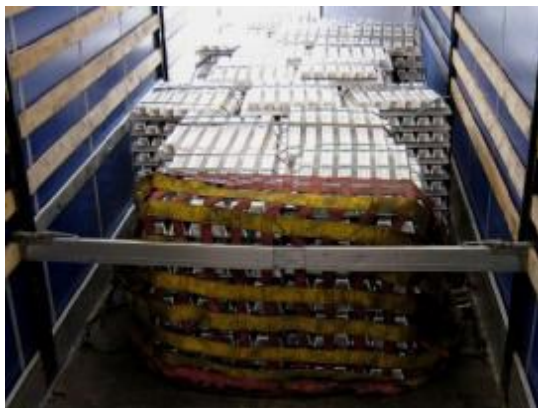
Upevnenie paliet dopredu sieťou AGRIFAIR – 4 pružné dvojité viazania do 20 ton
