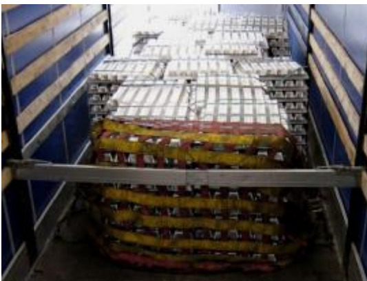
Upevnenie paliet dopredu sieťou AGRIFAIR – 4 pružné dvojité viazania do 20 ton
