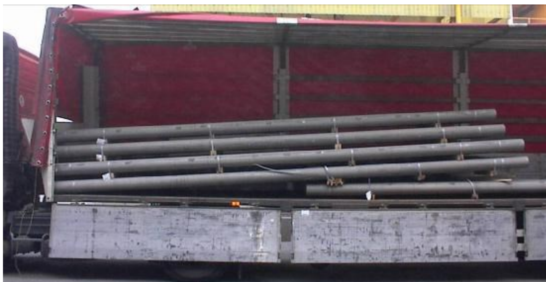
Posun 7 metrových výrobkov ( napr. nosníky) pri brzdení a prerazenie čelnej steny návesu
