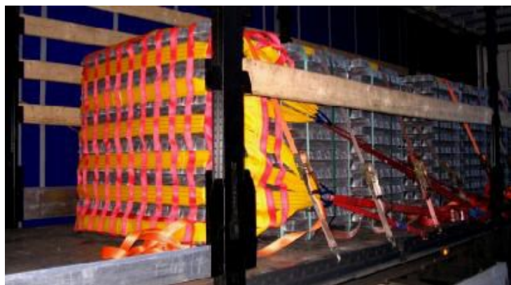
Upevnenie paliet dopredu sieťou AGRIFAIR – 4 pružné dvojité viazania do 20 ton
