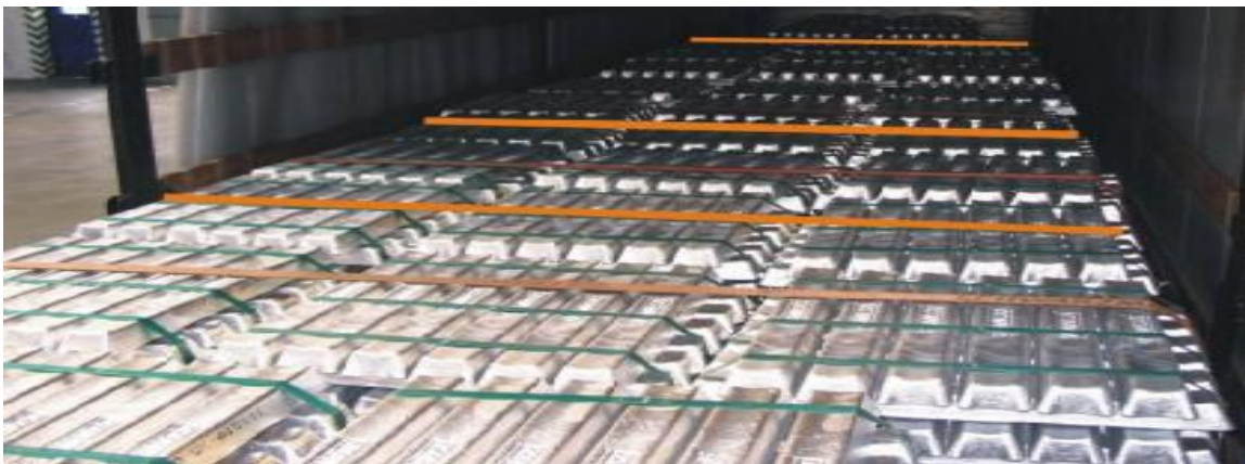
Kompaktný spôsob uloženia paliet (42 jednotiek) – každá sekcia upevnená vrchným viazaním - náklad blokováný o čelo vozidla dostatočnej pevnosti
