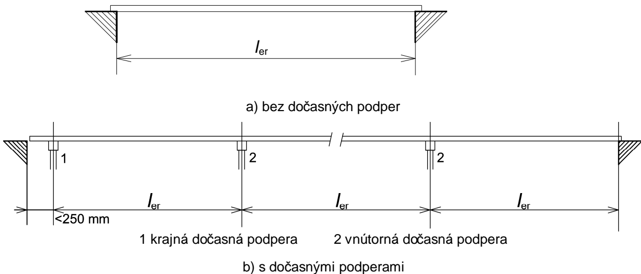
Obr. H.1 – Definícia rozpätí behom výstavby
